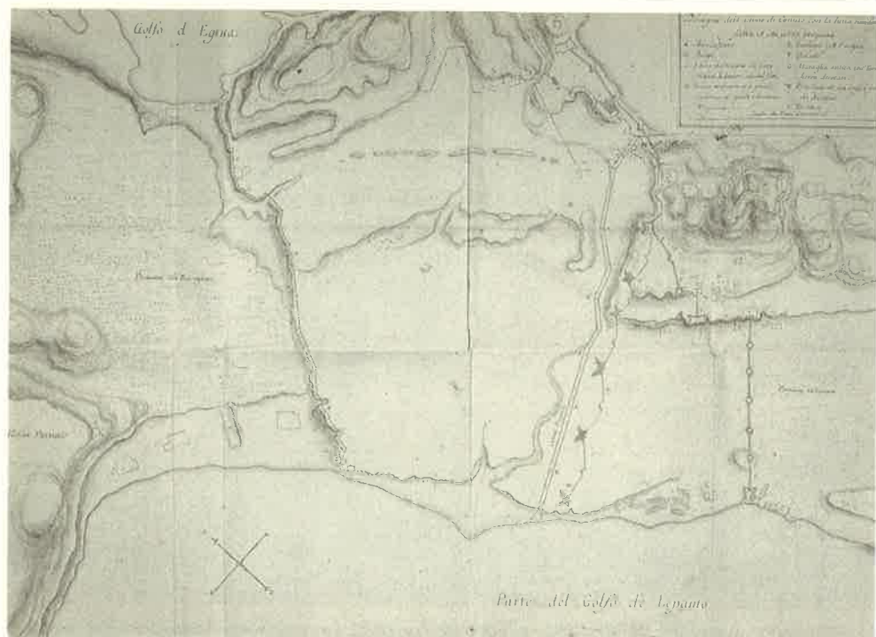
Ανώνυμο σχέδιο για τις οχυρώσεις τις Κορίνθου στο οποίο προτείνεται η διευθέτηση του Ξηριά σε πλατύ κανάλι. Αν το έργο είχε κατασκευαστεί θα είχαν ίσως αποφευχθεί στην Κόρινθο οι καταστροφικές πλημμύρες του περασμένου Ιανουαρίου. Τέλη του 17ου αιώνα. (Γεννάδειος Βιβλιοθήκη).
